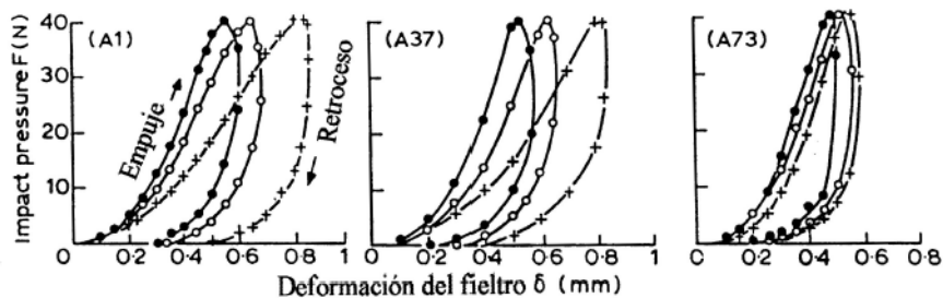
Figura 4.2: Deformación del fieltro en función de la presión de impacto (fuente: [8]).
